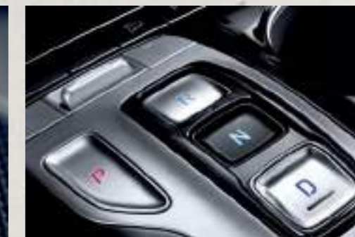
Cần số điện tử dạng nút bấm (Bản Dầu Đặc Biệt và Turbo)
