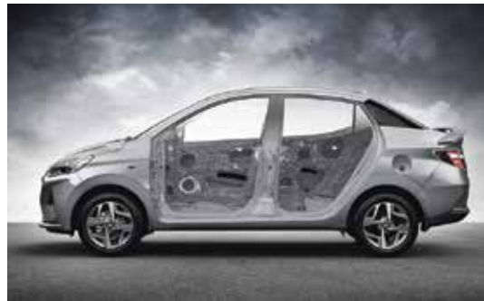
Hệ thống khung mới cứng vững hơn với thép cường độ cao
