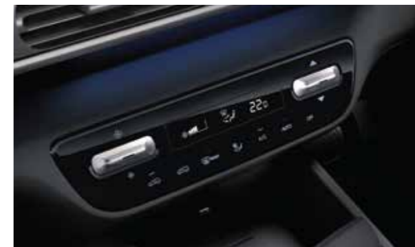
Hệ thống điều hòa tự động
